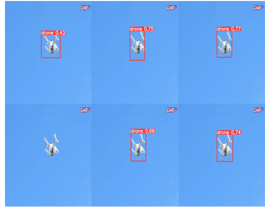
그림 6. 안티-드론 객체 탐지 예시 (위쪽: COCO 데이터셋, 아래쪽: Pascal VOC 2012 데이터셋) Fig. 6. Examples of anti-drone object detection
